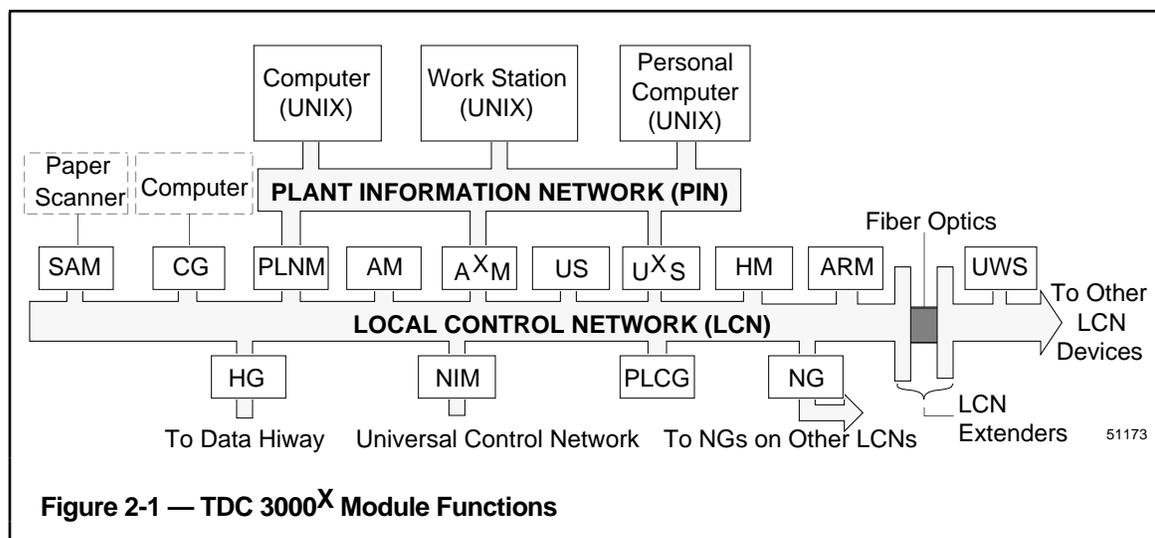
**Figure 2-1 — TDC 3000<sup>X</sup> Module Functions**
